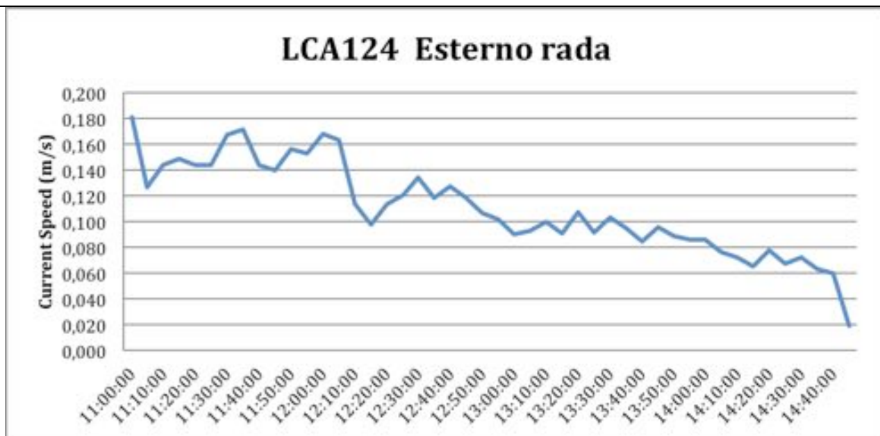
Figura24. Serie temporale della corrente registrata attraverso il drifter LCA124 tra le ore 10:55 e le ore 14:45 del 20 Ottobre 2017.
