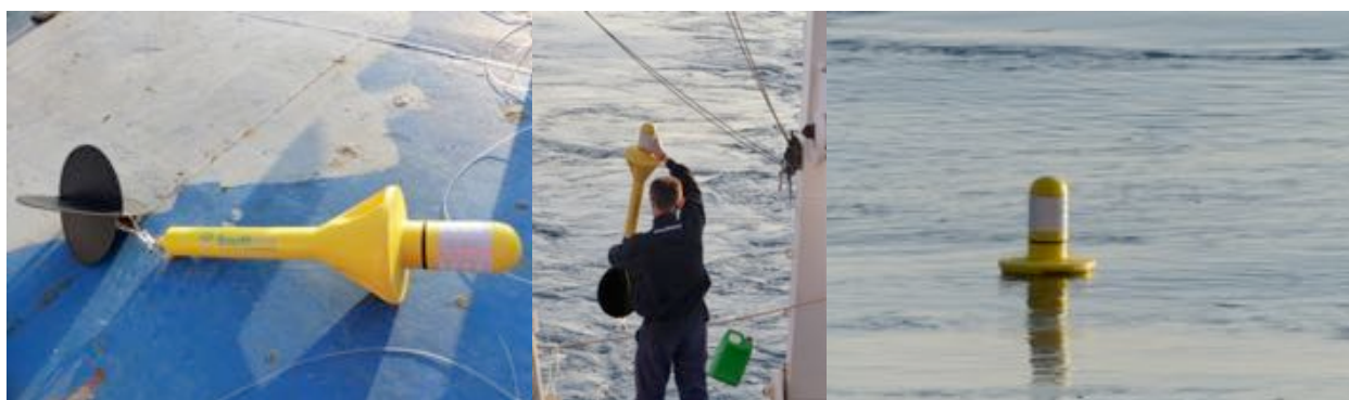
Figura 17. Uno dei drifter utilizzati nelle tre fasi: in nave, al lancio, in mare.
